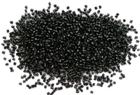
A linha KARINVOLT® compreende em compostos termofixos, anti-chama, livre de halogênios, com baixa emissão de fumaça e gases tóxicos. Destinado à aplicação em cabos, conhecidos comumente como fotovoltaicos, amplamente utilizado em isolamento e cobertura para atendimento as normas ABNT NBR 16612.
