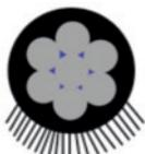
CONDUCTOR CON SEMI-CONDUCTORA
