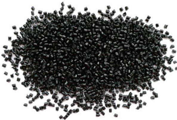
La línea KARINVOLT® comprende compuestos termofijos, ignífugos y sin halógenos, con bajas emisiones de humo y gases tóxicos. Se destina a la aplicación en cables, comúnmente conocidos como fotovoltaicos, ampliamente utilizados en aislaciones y cubiertas para cumplir con las normas ABNT NBR 16612.
